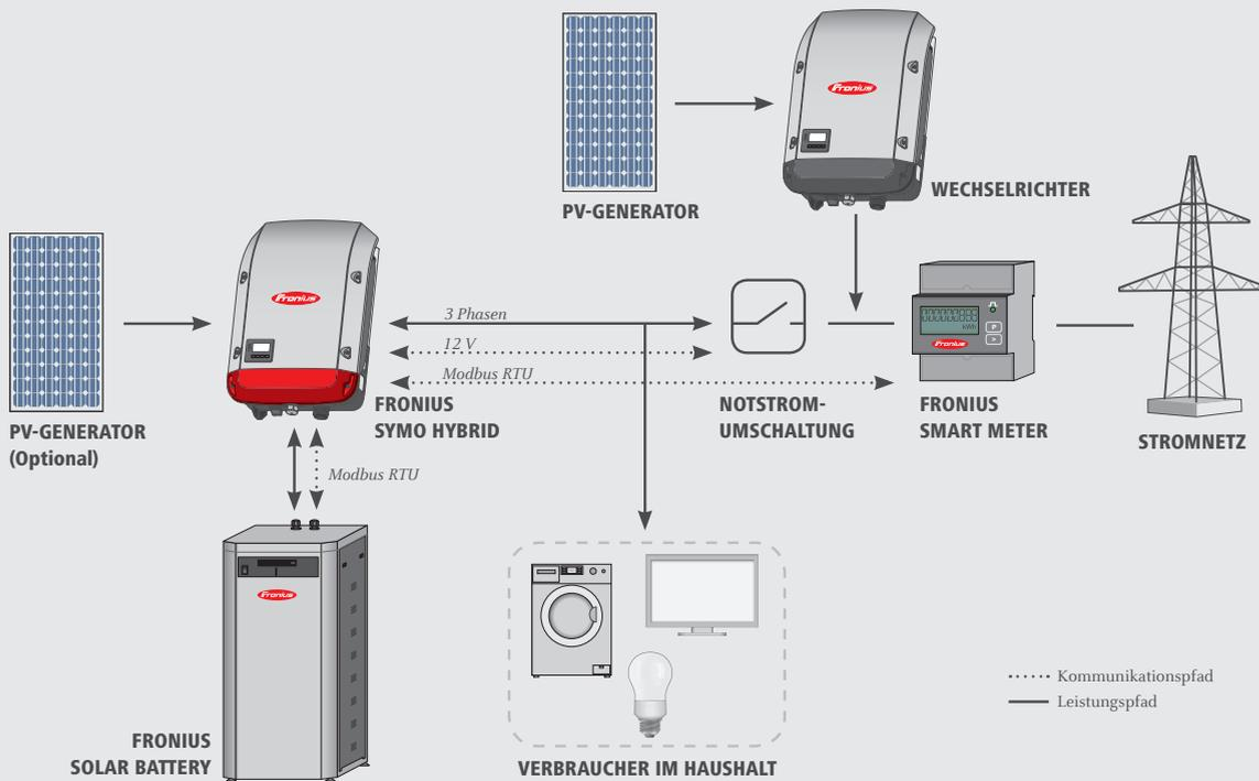
Die Notstromfunktion ist beim Fronius Symo Hybrid ab Mitte des Jahres 2016 einfach per Software-Update erweiterbar.
